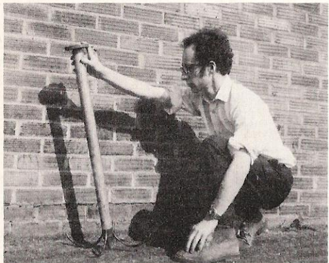
• المعلم الأرضي قبل تركيبه بين الغطاء السطحي البرونزي وقاعدة التثبيت Ground marker before installation showing bronze surface cap and anchor base.
